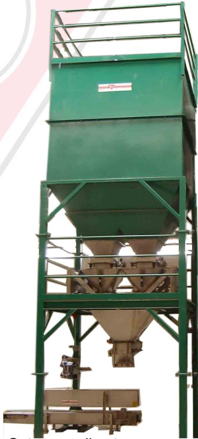
Cet appareil est conçu pour le remplissage automatique de sacs de 15 à 50 kilos. Il peut traiter aussi bien des poudres que des granulées.
