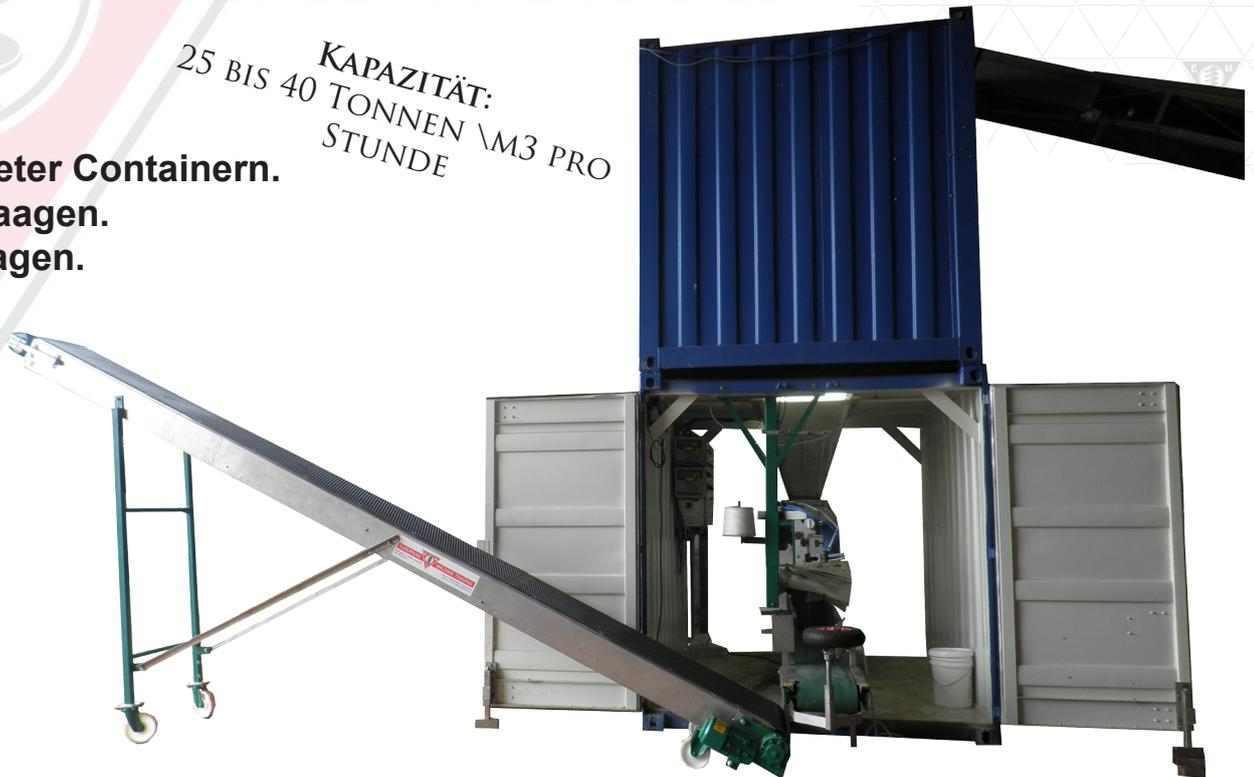
**EMT hat ein 20 bis 50 kg Taschensystem entwickelt, dass in zwei Normalstahlcontainern von drei Metern integriert ist.**
