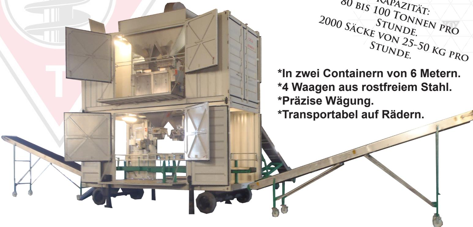
**Eine doppelte Sackabfüllanlage integriert in zwei normale Container von sechs Metern.**
