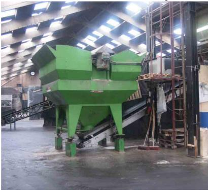
поток смешения. Машина загружается при помощи погрузчика, если она полностью открыта. Исходные продукты смешиваются в готовую смесь быстровращающимся смесительным шнеком. Процесс приготовления смеси занимает 3 минуты. Разгрузочный затвор открывается вручную, и смесь вытекает на передаточный транспортер. Смесительный шнек изготовлен из малоуглеродистой стали, он размещен в трубе из нержавеющей стали и оборудован нижним подшипником.
