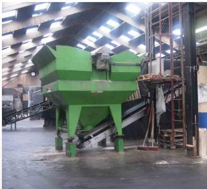
alimenté par godet de bull ou de chariot élévateur qui verse le produit en haut du mélangeur. À l'intérieur, une vis à grande vitesse fait monter le produit qui coule constamment dans le cône. Le temps de mélange est de 3 minutes et le produit sort par une vanne à ouvrir manuellement et tombe sur un convoyeur ou un autre récipient. La vis est fabriquée en acier doux, montée dans une tube en inox et fixée dans un palier en bas. En haut, la machine est équipée d'une grille afin d'éliminer des
