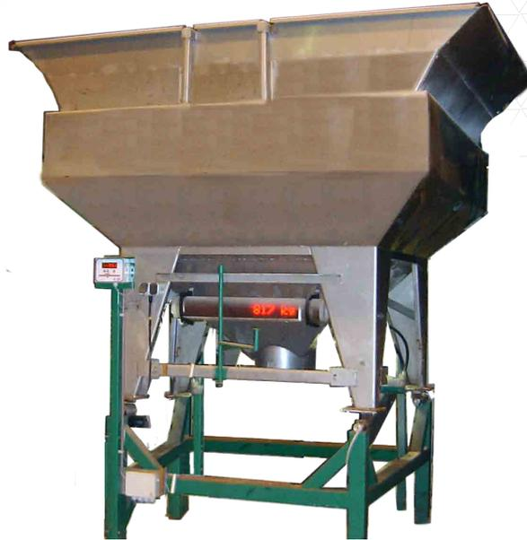
Le mélangeur Smithbuilt peut mélanger des engrais en granulés. Le mélange des matières premières est homogène. Les mélanges peuvent être introduits dans une ligne d'ensachage. Le mélangeur est conçu pour mélanger des petits volumes et est peu encombrant.
