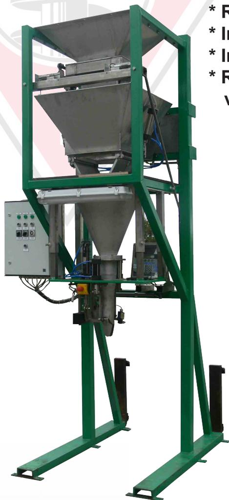
Cet appareil est spécialement conçu pour l'ensachage de petits sacs de 25 jusqu'à 50 kilos. Le châssis est mobile et peut être installé en dessous d'une trémie existante.
