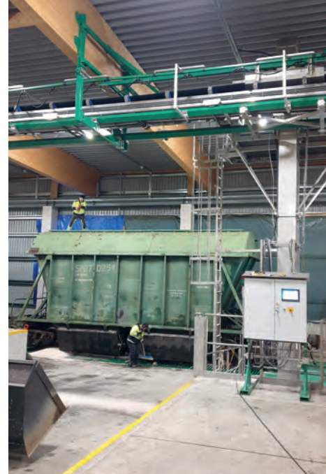
Afb. 3b Een treinwagon lost grondstoffen in de stortput.
