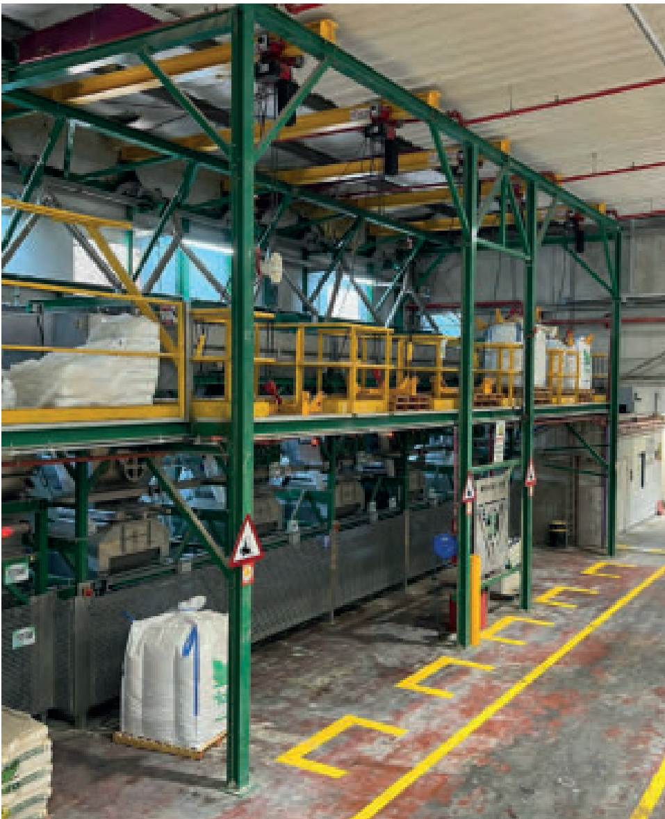
Afb. 1 Big bag invoerhoppers met kettingtakels
