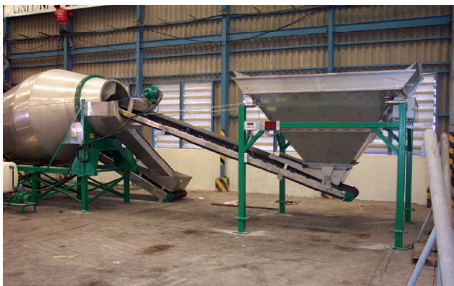
Afb. 1 Een Shamrock (links) met verzameltrichter
