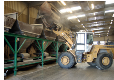
Afb. 6 Het navullen van de weegtrechters van een Weighcont
