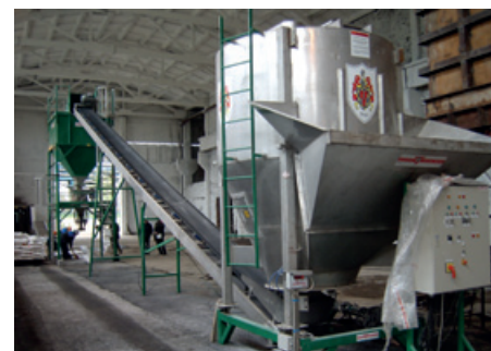
Afb. 3 Een Vertical met geïntegreerde vulbak
