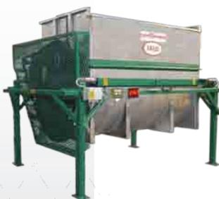
El brazo de agitación dentro de la máquina mueve el material a la compuerta de descarga cuando la máquina se está descargando. El número de rotaciones de este brazo es de 5 veces por minuto. El proceso de mezcla dura 3 minutos. Un
