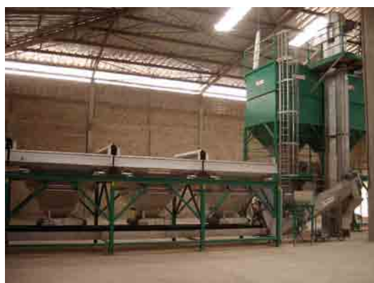
3 бункерный смеситель Вейконт + линия затаривания для малых мешков
