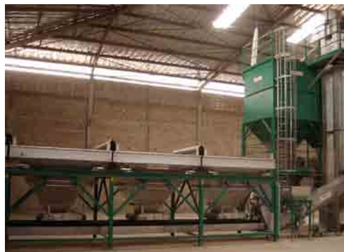
Weighcont à 3 trémies avec ensacheuse petits sacs
