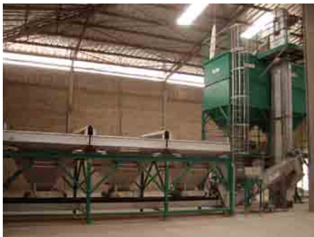
3 Wägebältern Weighcont Mischer und Small Bag Abfüllmaschine
