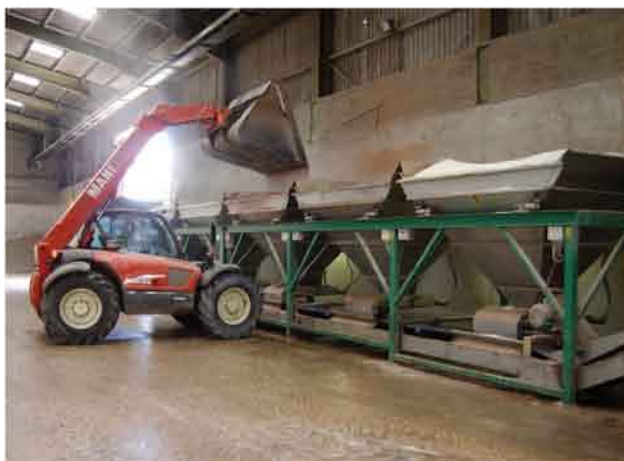
Abf. 3 Een Weighcont menginstallatie voor de productie van kunstmest
