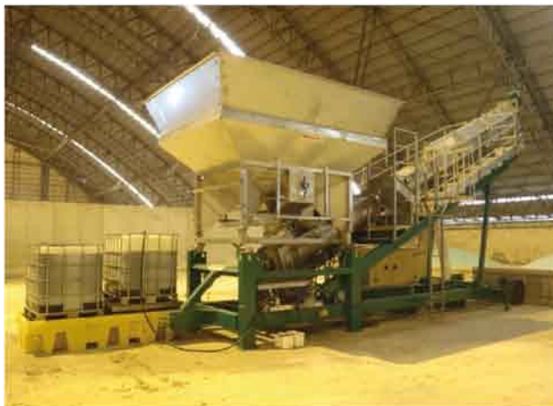
Abf. 2 Een verplaatsbare kluitenbreker- en coatinginstallatie in Australië
