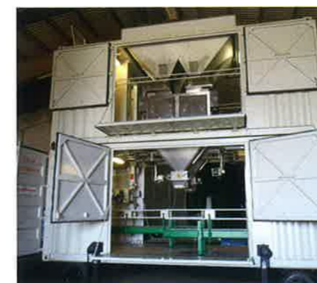
Afb. 5 Een duo-verpakkinglijn met Weighcont-blenders
