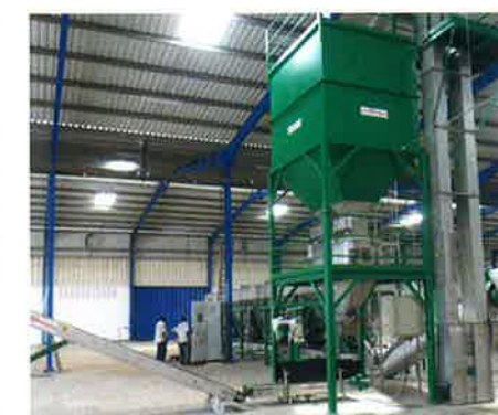
Afb. 4 Een Weighcont blender met een verplaatsbaar 25-50 kg zakkenvulstelsel
