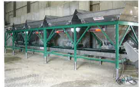
Afb. 3 Een Weighcont-menginstallatie met vijf weegtrechters
