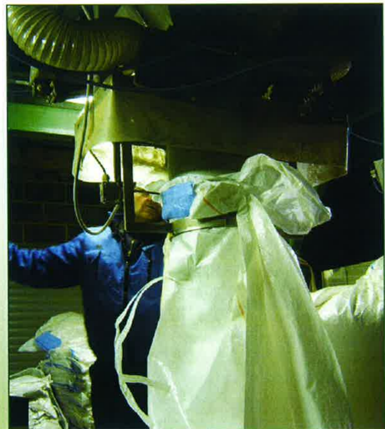
Afgewogen tijdens de 'verloren' tijd, nodig voor het sluiten en afvoeren van de volle bigbag, levert tot 40% tijdswinst op
