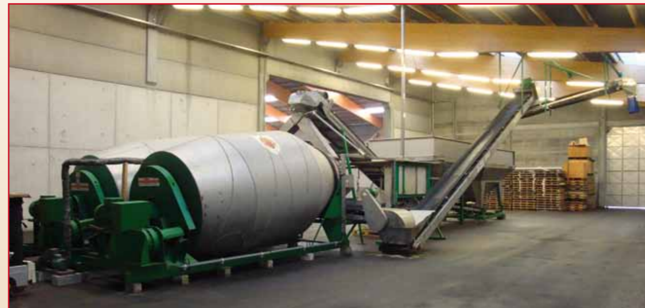
Een opstelling van weegmengers en blenders maakt leveringen van mixen kunstmest op klantspecificaties mogelijk
